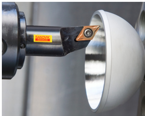
Державка: A20M-ADXCL 11-R Пластина: DCGT 11T308-UM 1115
