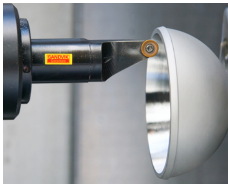
Державка: A20M-SRXDL 08-R Пластина: R300-0828E-PL 1030
