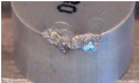
Фреза с керамическими пластинами, сплав пластины CC6060, z_n 4, D_3 63 мм, v_c 1000 м/мин, a_e 32 мм, f_z 0.12 мм/зуб, a_p 1.5 мм, Материал: Waspalloy
